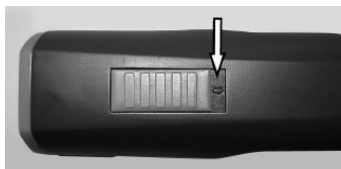
Fig. 4 Kontakt i OFF-position ("0")
